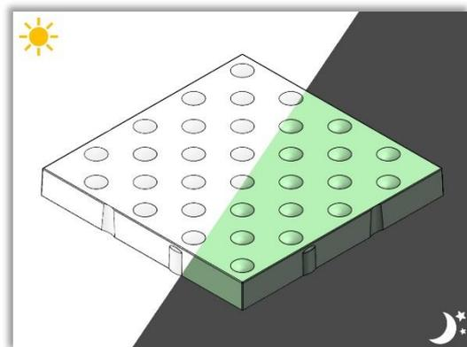
Les dalles podotactiles en béton luminescent Taglight sont des dalles en béton dont la surface est luminescente.
