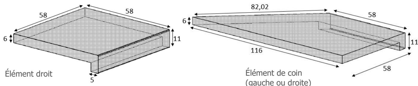
Les margelles en béton Interblochs sont texturées et anti-dérapantes sur la surface supérieure.
